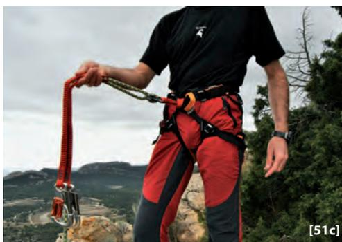
Casi todos los cabos disipadores comerciales vienen provistos de una cinta plana cosida incorporada en la parte inferior del disipador para poder fijarlo al arnés.
